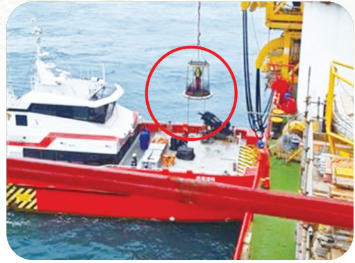
▲ 圖4：勞動檢查員人員由人員運輸船轉移透過海上人員運輸專用運具轉移至工作船
