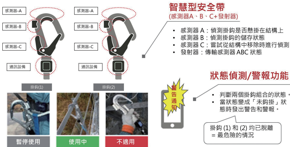
▲ 圖 3：物聯網科技在降低墜落風險的國外應用案例
