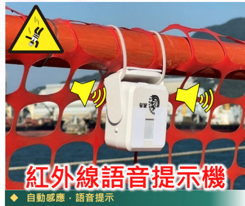
▲ 圖 4：感應式廣播設備在降低墜落風險的國內應用案例
