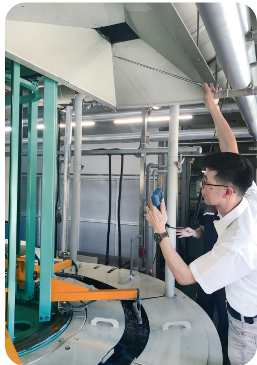
▲ 局部排氣裝置性能測試
