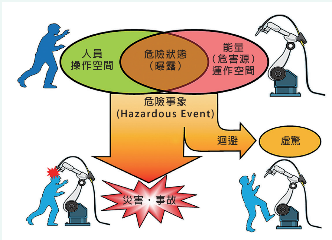
圖3 人機作業系統之危害源與危險事象 (日本中央勞動災害防止協會)
