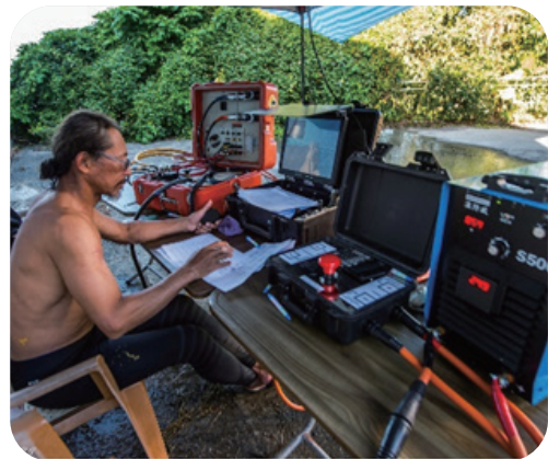
▲ 圖 4：透過通訊系統及影像顯示器，岸上控制台能隨時監控學員並掌握水中銲接之操作訓練過程 圖片來源：本所拍攝
