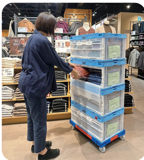
▲ 公司設計以「側開式附輪物流箱」來承裝商品，利用箱體下方的輪子使搬運過程更便捷。改良後的物流箱讓中高齡員工補貨更省時省力
